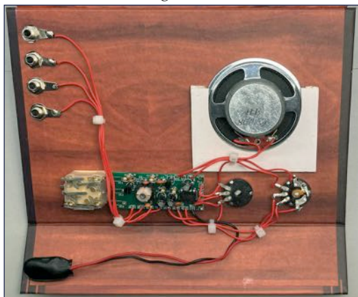
Fig: Inkråmet är nu klart med kabeldragning, och redo för strömsättning.
